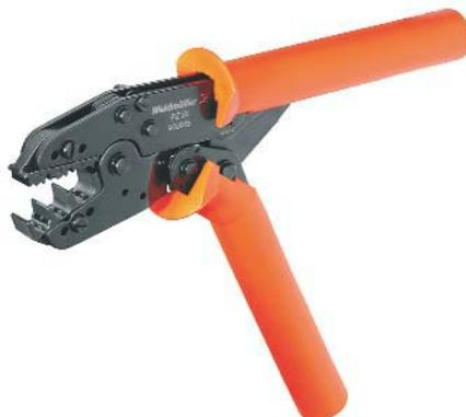
Инструмент для обжима кабельных наконечников с сечением 25, 35 и 50 мм<sup>2</sup>, с пластиковыми втулками или без пластиковых втулок, соответствующих DIN 46228 части 1 и 4 (~ AWG 3...1)
