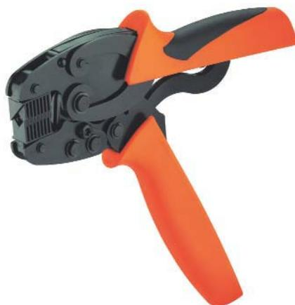
Инструмент для обжима кабельных наконечников с сечением 0,5...6 мм<sup>2</sup>, с пластиковыми втулками или без пластиковых втулок, соответствующих DIN 46228 Т 1 и 4 (~AWG 20...10), и двойных наконечников с сечением 0,5...4 мм<sup>2</sup>
