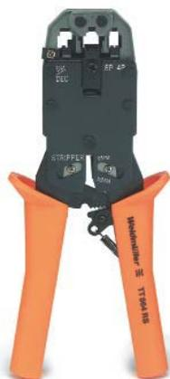
Нарезает кабель, снимает изоляцию и обжимает максимум 8-полюсные разъемы на ленточных или овальных сигнальных кабелях:
