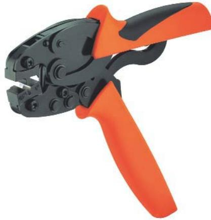
Инструмент для обжима кабельных наконечников (соответствующих DIN 46228 части 1 и 4) с пластиковыми втулками или без пластиковых втулок, с сечением 0,5...4 мм<sup>2</sup> (~ AWG 20...12), и двойных наконечников с сечением 0,5...2,5 мм<sup>2</sup>
