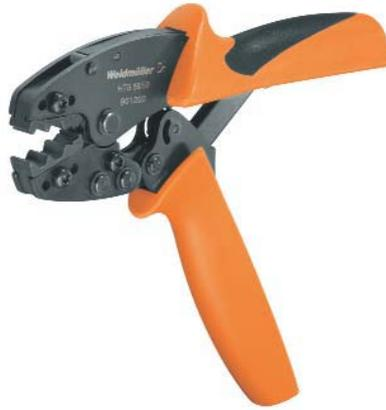
Инструмент для обжима коаксиальных разъемов, например, BNC- и TNC штекеров на кабеле RG 58, RG 59, RG 62 и RG 71. Штекеры RG 62 и RG 71 можно обжимать только в гнезде для RG59!
