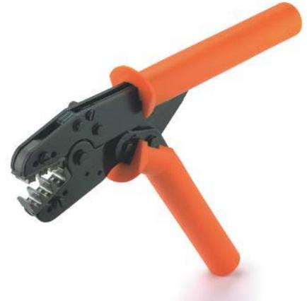
Инструмент для обжима двойных кабельных наконечников (соответствующих DIN 46228 T. 4) с пластиковыми втулками, с сечением 6...16,0 мм<sup>2</sup> (~ AWG 10...6)
