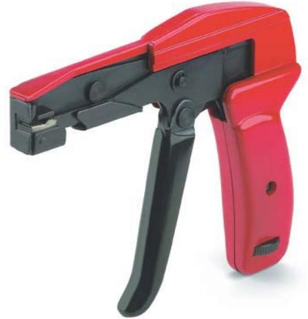
RT 1 - компактный инструмент для затягивания и обрезки кабельных хомутиков в одном рабочем цикле. Усилие затягивания регулируется в широком диапазоне с учетом размера хомутика. RT 1 подходит для работы с кабельными хомутиками и для обвязки жгутов диаметром от 1,6 мм до 100 мм
