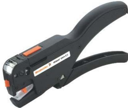
Инструмент для нарезки кабеля, снятия изоляции и обжима соединенных кабельных наконечников Weidmüller с сечением 0,5...2,5 мм<sup>2</sup> (~AWG 20...14)
