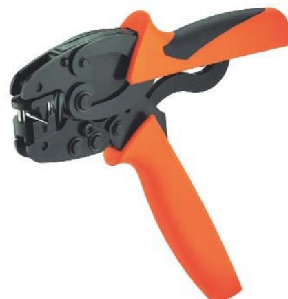
Инструмент для обжима кабельных наконечников с сечением 0,14...6 мм<sup>2</sup>, с пластиковыми втулками или без пластиковых втулок, соответствующих DIN 46228 Т 1 и 4 (~AWG 26...10), и двойных наконечников с сечением 0,5...4 мм<sup>2</sup>
