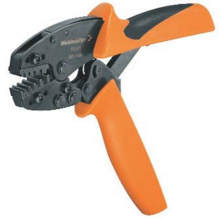
Инструмент для обжима кабельных наконечников (соответствующих DIN 46228 Т. 1 и 4) с пластиковыми втулками или без пластиковых втулок, с сечением 0,25...6 мм<sup>2</sup> (~ AWG 24...10), и двойных наконечников с сечением 0,5...4,0 мм<sup>2</sup>
