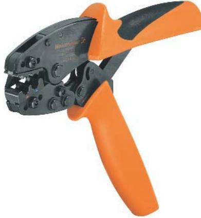
Инструмент для обжима разъемов с изоляцией из ПВХ, поликарбоната и полиамида, с сечением 0,5...2,5 мм<sup>2</sup> (AWG 20 ... AWG 14)
